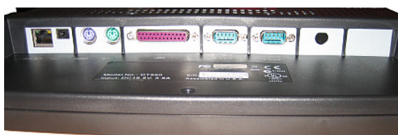
Anschlüsse unten: RJ45, DCin, 2x PS2, LPT, 2x COM
