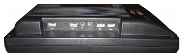
Anschlüsse seitlich: 4x USB2.0, Audio in/out
